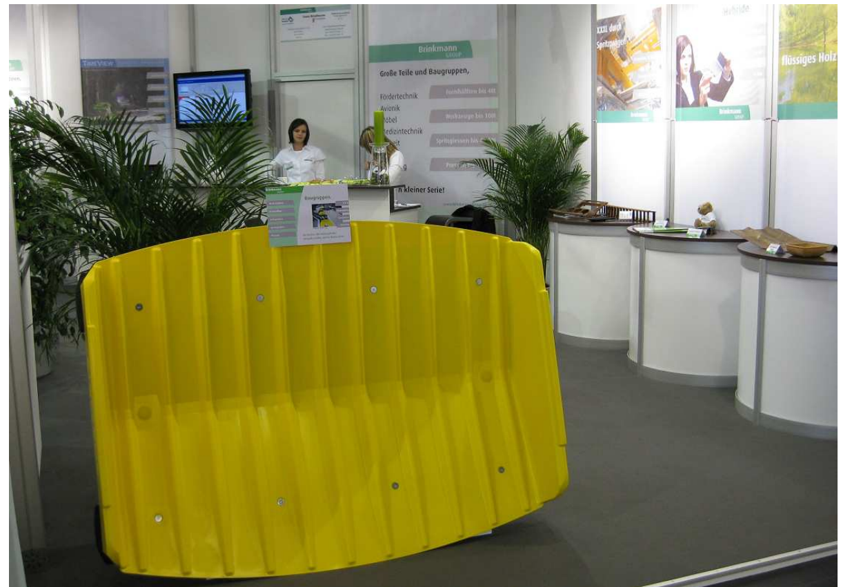
1,6 m 2 großer Artikel – Herstellung im Spritzprägeverfahren
